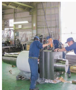
30型ロールプレス機、 ローラー組立風景
