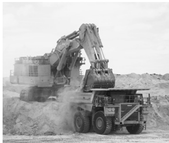
海外で活躍する超大型油圧シャベルとダンプトラック 写真提供：日立建機(株)
